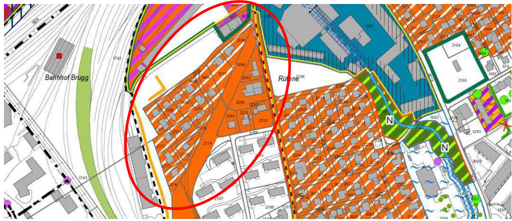
Abbildung 24: Ausschnitt Änderungsplan mit Umzonung W3 in die Nachverdichtungszone (weiss schraffiert) Untere Reutenenstrasse und W3 in die WA3 zwischen der Lagerstrasse / U. Reutenenstrasse
